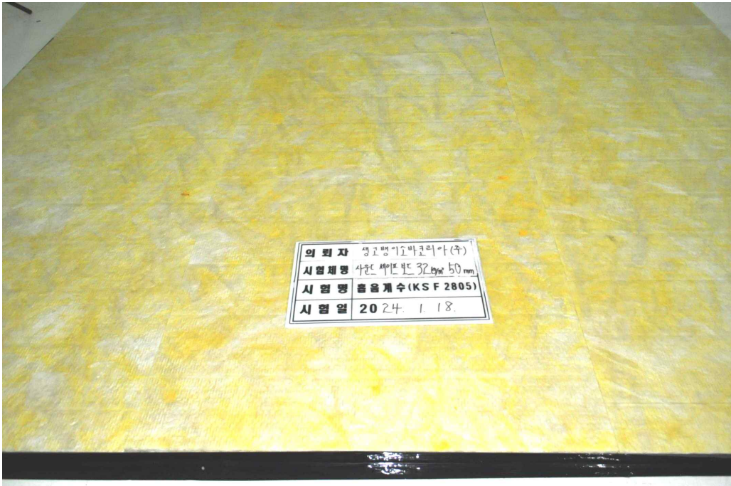
[사진 1] 시료 설치모습
